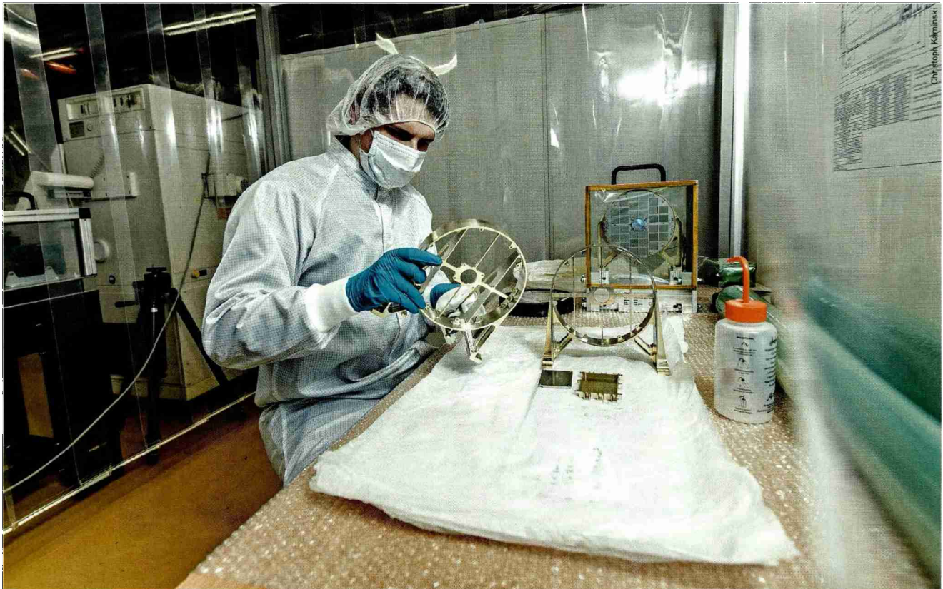
Im Reinraum wird das an der FHNW entwickelte Röntgenspektrometer zusammengesetzt. In zwei Jahren startet es mit einem Satelliten Richtung Sonne.
